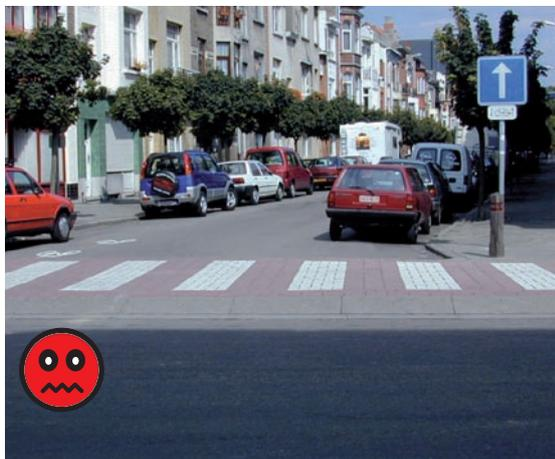
*Dans ce contre-exemple, le trottoir traversant est correctement réalisé cependant le marquage de la traversée ne peut pas être réalisé.*
