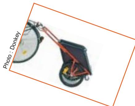
☞ La **Multirette®** remorque à 2/3 bacs gérables ou emboîtables. Longue d'1 mètre, elle pèse 5,7 kg, et a une capacité de charge de 20 kg. Vendue 75 euros (sous réserve de modification).
